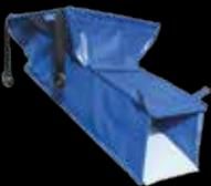
Ausfallsäcke reduzieren Ausschuss und verhindern die Verschmutzung der produzierten Teile
